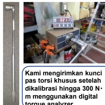
Kami mengirimkan kunci pas torsi khusus setelah dikalibrasi hingga 300 N·m menggunakan digital torque analyzer.
