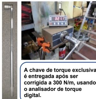
A chave de torque exclusiva é entregue após ser corrigida a 300 N/m, usando o analisador de torque digital.
