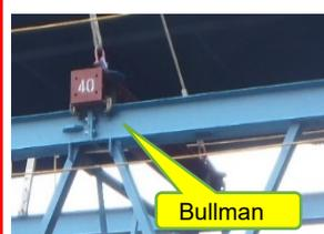
Proibido içamento de material de aço, etc. (Proibida tensão na direção axial)
