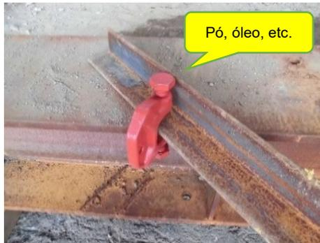
É preciso remover pó e óleo da parte da junção. Como a resistência diminui quando há substâncias estranhas nessa parte, remova-as e faça a junção.
